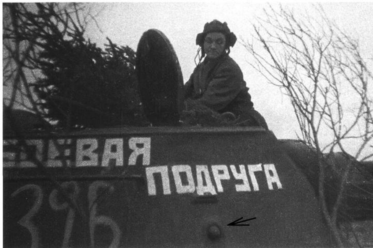
Танк «Боевая Подруга» имеет пистолетную бойницу с бронепробкой, что является отличительной чертой омского танка Т-34. Г 24 Т 824.
